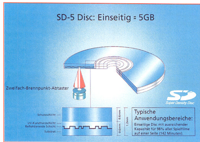
Bild 5: Der Aufbau der 5-Gbyte-Standard-DVD. Grafik: SD-Konsortium
