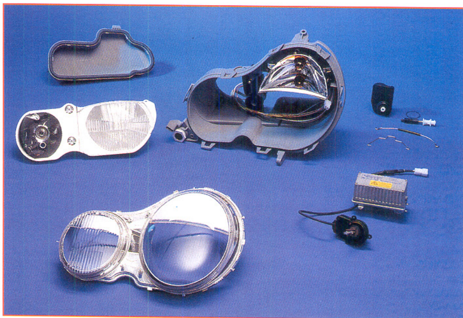
Bild 5: Die Bestandteile des Xenon-Scheinwerfers der Mercedes-Benz E-Klasse. Man erkennt deutlich die erstmalig auswechselbare und nahezu völlig glatte Scheinwerferabschlußscheibe aus Kunststoff. Foto: Mercedes-Benz.
