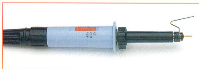
Bild 63: Tastkopf-Massefeder zur Verringerung der Masseanschluß-Induktivität
